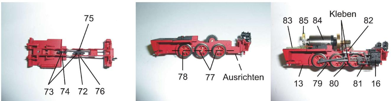
Die vordere Schraube **106** dabei vorübergehend fixieren. Die Leiterplatte **83** aufschrauben und den Gleitbahnträger **82** und den Motor **84** aufkleben, dabei das Schneckenspiel kontrollieren. Nachdem die Kabel und der Kondensator
