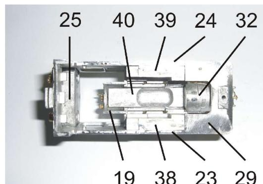
Nachdem die Teile **19-22** zusammen geklebt sind, können diese auch am Gehäuse angebracht werden. Jetzt wird probeweise das Dach **34** aufgesetzt und mit den Teilen **35-37** bestückt.
