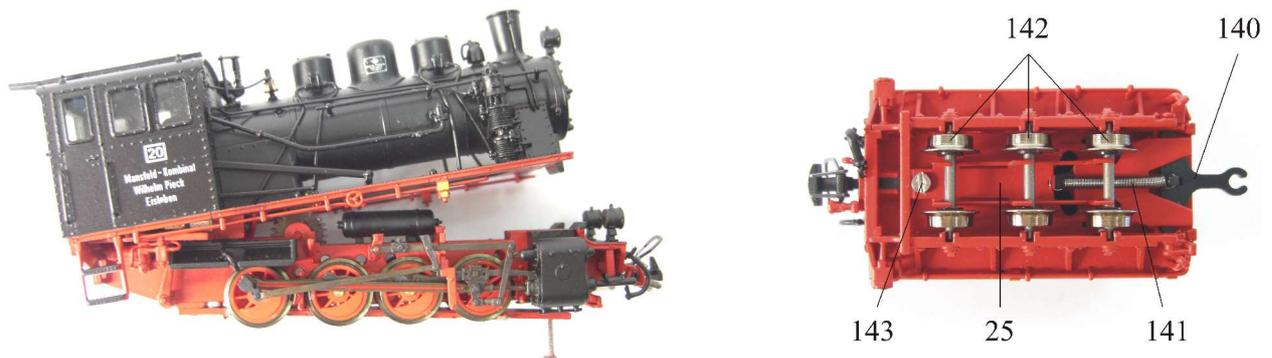
Jetzt setzt man den Tender aus Ober- und Unterteil zusammen, baut noch die Teile **25**, **140-142** ein und fixiert alles mit der Schraube **143**. Die Räder müssen dabei etwas gefettet werden. Zum Schluss klebt man nun nur noch die Kupplungen ein und die Lok ist fertig.
