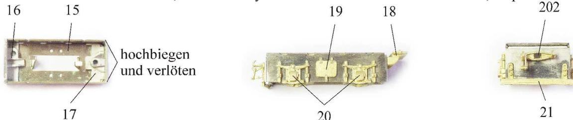
Anschließend wird das Tenderunterteil **15** gebogen, gelötet und gewaschen. Zuletzt werden die Teilen **16-21** und **202** montiert. Dabei die Räder probeweise einsetzen.
