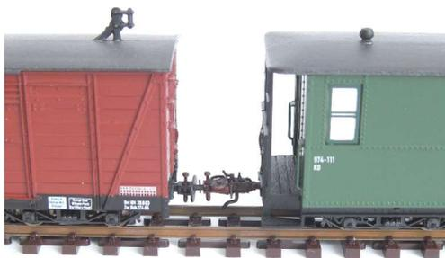
Scharfenbergkupplung mit Adapter an 2- Achser
