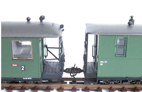
Scharfenbergkupplung mit Adapter an Rollwagen
